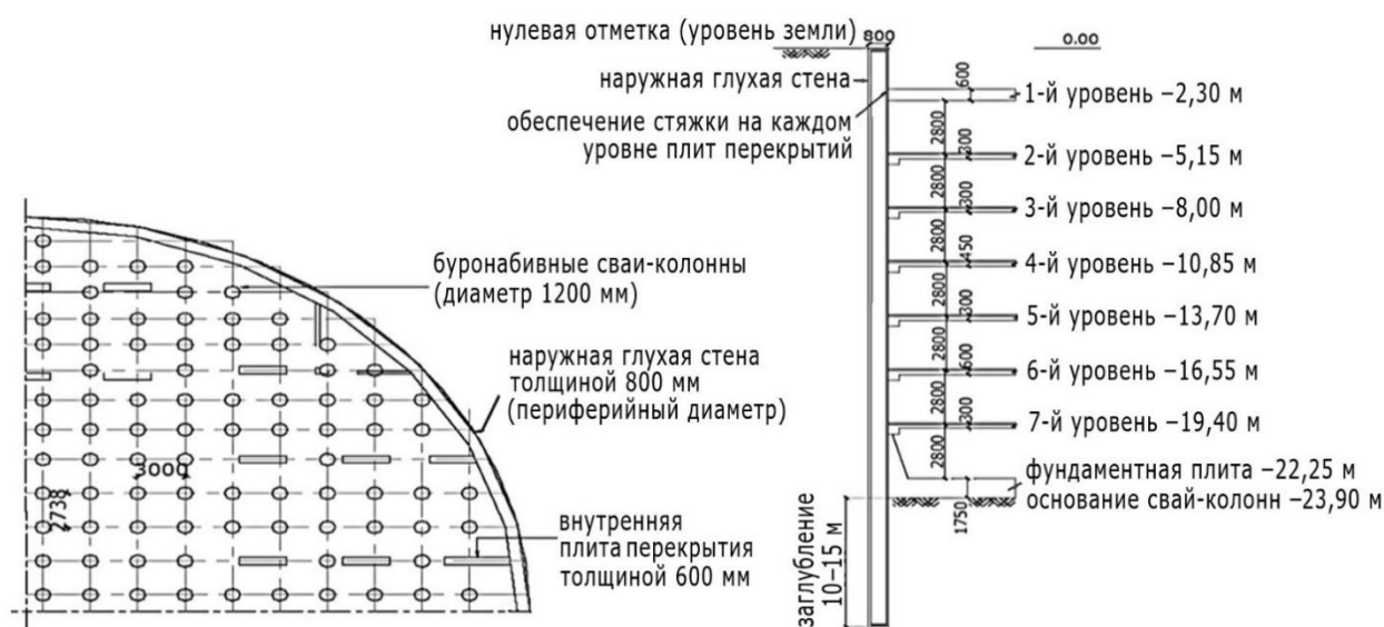
Рис. 4.6. Строительство подземной многоуровневой автостоянки методом «top-down» в Дели
