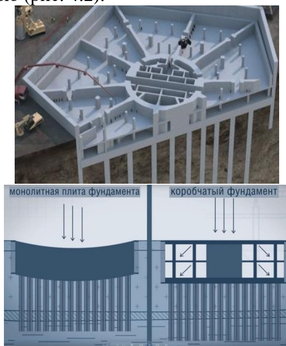
Рис. 4.2. Конструкция коробчатого фундамента башни «Лахта Центр»
